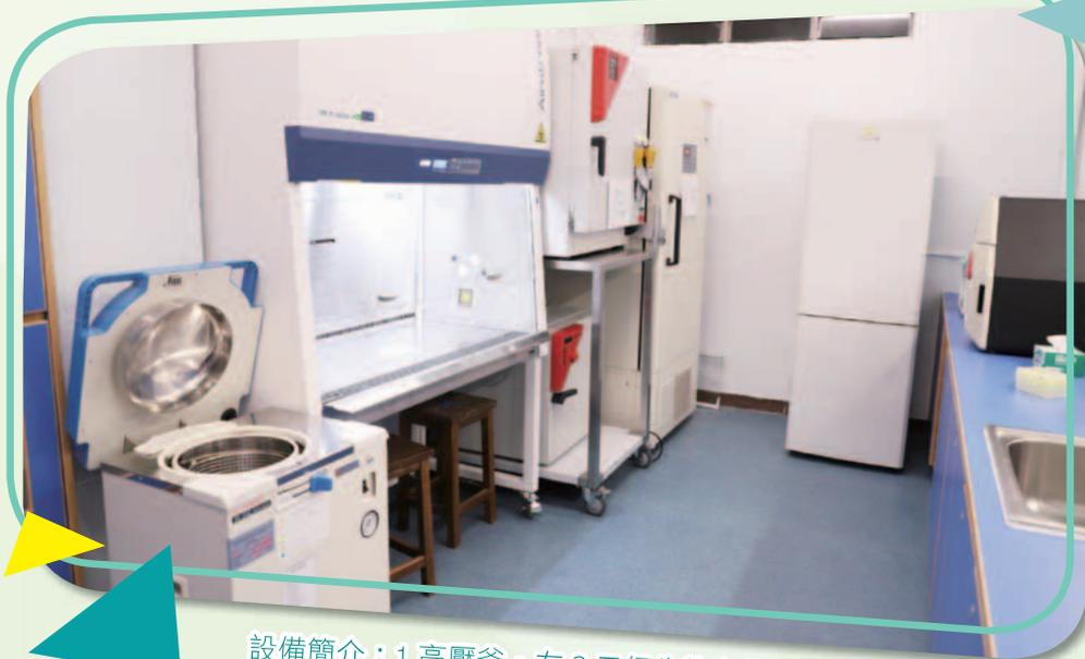
設備簡介：1 高壓釜，左 2 二級生物安全櫃，左 3 細胞培養櫃，左 4 超低温冷藏庫
