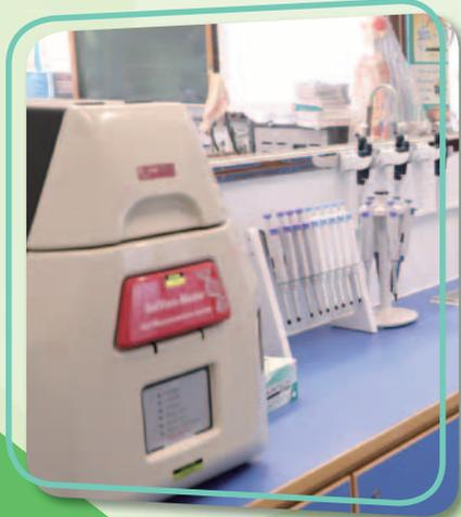
左 1 凝膠成像系統，左 2 移液管
